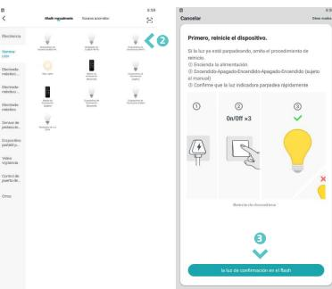
5. Reinicie el dispositivo: reiniciar el dispositivo significa que debe hacerlo parpadear para que entre en modo de configuración.
